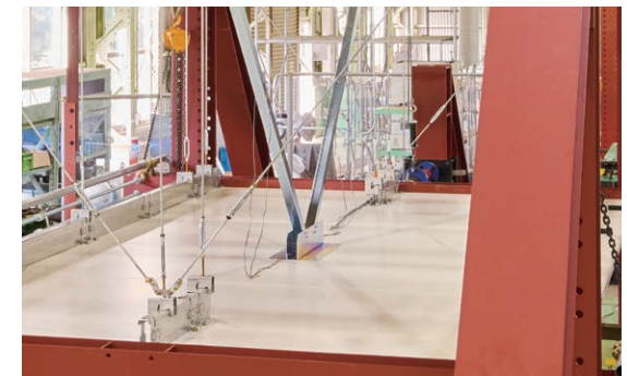
〈水平震度法に基づく水平加力試験を実施〉
